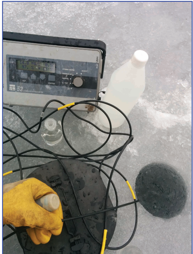
Kuva 3. Happimittaukset sondilla Särkjärven jäällä.
