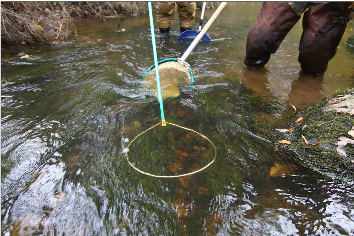
Kuva 15. Sähkökalastuksessa veteen johdetaan tasavirtakenttä, joka muodostuu ”anodihaavin” renkaan ympärille. Sähkökentässä kalat uivat näkyviin tai lamaantuvat ja veden virtauksen viettäväksi. Kalat pyydetään haaveilla ja mittausten jälkeen ne vapautetaan takaisin kotikoskeensa. Sähkökalastusta voidaan tehdä matalilla koskialueilla ja se sopii hyvin lohikalojen poikastutkimusten tekoon.
