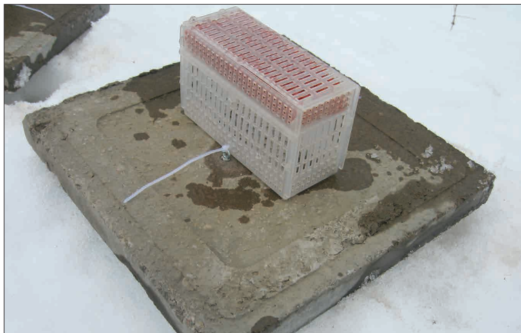
Kuva 38. Mätirasia kiinnitettynä painolaattaan.
