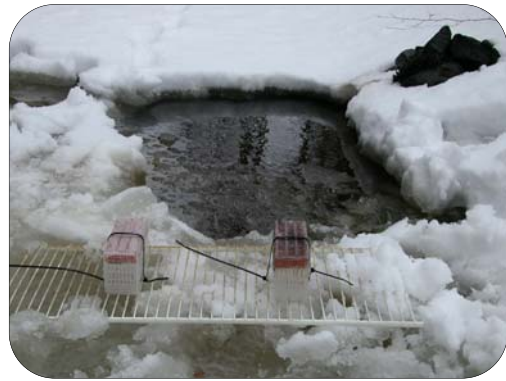
Kuva 103. Rasiat sijoitetaan puroihin ja koskiin ennen kevättulvan alkua. Rasiat on sijoitettu erillisiin suojakehikoihin tai ritilöille. Vedessä kehikot ja ritilät peitellään kivillä siten, että rasioiden läpi käy hidask virtaus. Kiviä tulee olla painona runsaasti, muuten kevättulva vie rasiat kehikoineen mennessään.
