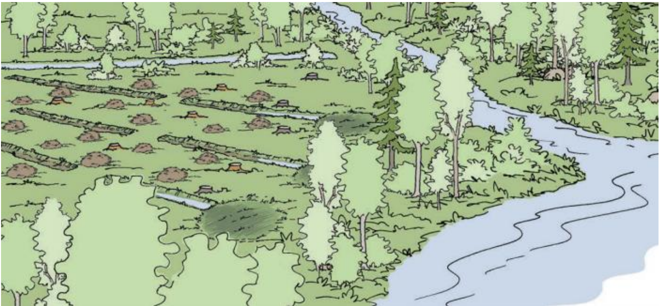
Kuva 14. Naveroilla ei johdeta vettä pois uudistusosalta ja niiden päässä saa olla seisovaa vettä, koska niillä ei tavoitella pysyvää kuivatusta. (Metsätalouden vesiensuojeluopas 2007).
